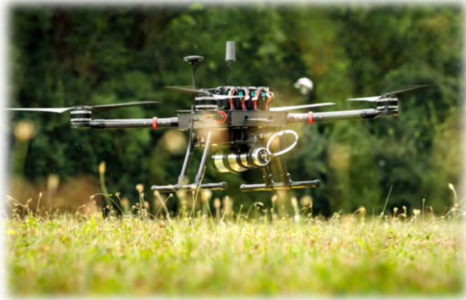
Système NaI 3''x3'' ( \approx 2 kg) + drone Teremys ( \approx 10 kg)
