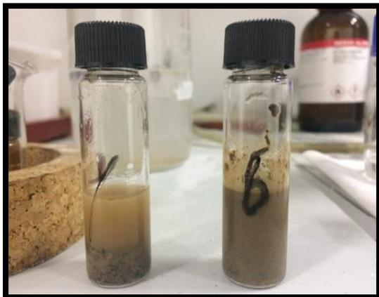
Figure 5 - Deux Vials après agitation magnétique pendant 15 minutes (5000rpm) suivie d'ultra-sons pendant 5 minutes à 37 kHz
