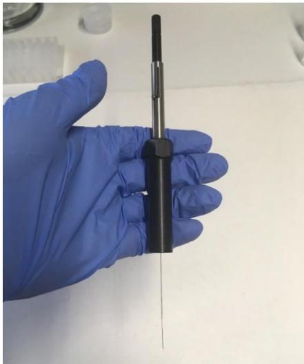
**Image 2** : Dispositif SPME avec déploiement de la fibre
